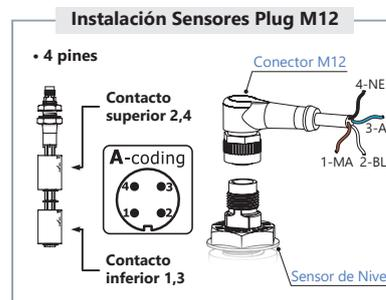
**¡Importante!** Conexión del Sensor con:
