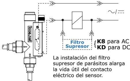
¡ No conectar nunca directamente a un motor, lámpara o cualquier carga superior de 20W ! Utilice siempre un contactor o relé.
