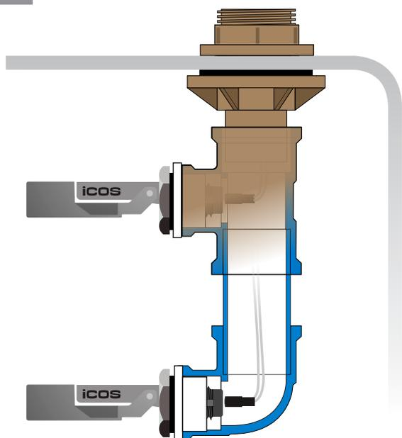
**Adicione quantos pontos de Controle de Nível desejar, encaixando no tubo pares de Sensor+Adaptador na altura ideal.**
